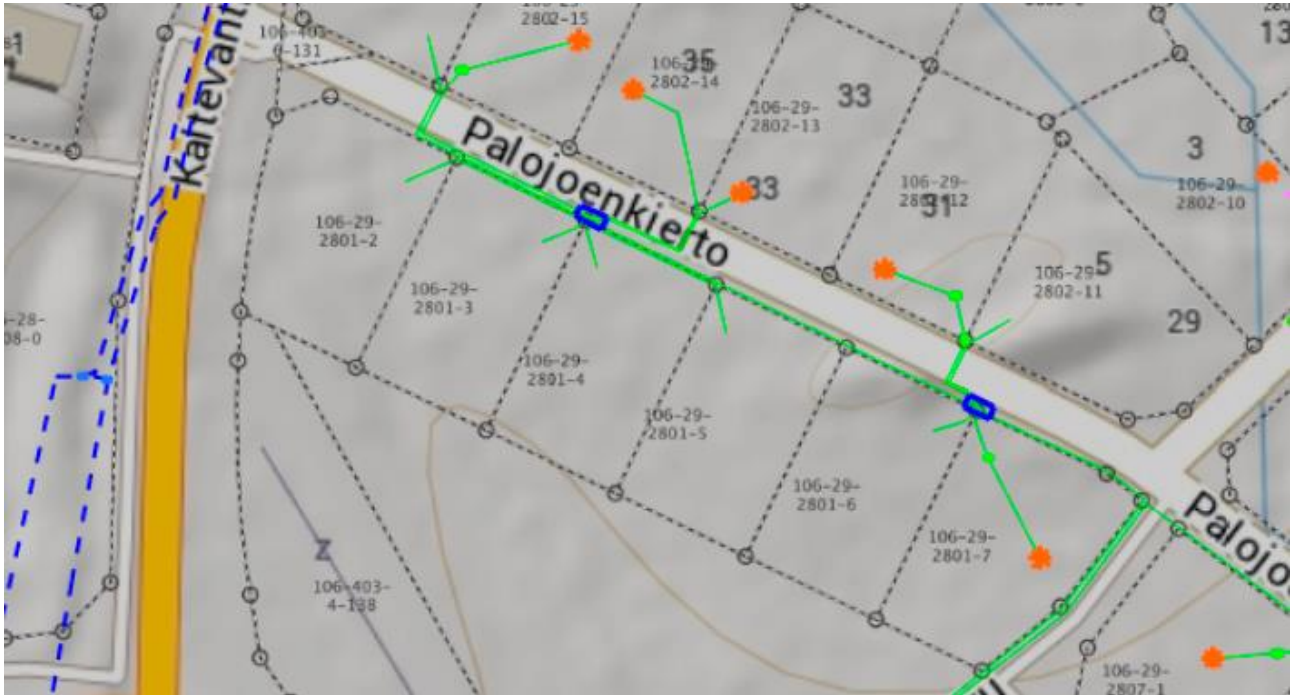
Kuva 7. Alueen sähköliittymien ja -kaappien sijainnit. Lähde: Caruna Oyj, 2020.
